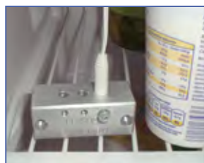
Aluminiumblock verzögert die Ansprechzeit des Fühlers Aluminium block delays the response time of the probe
